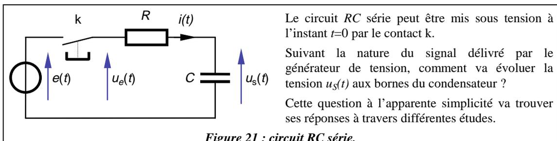
Si le générateur délivre une tension continue (permanente), dès la fermeture de k la tension  $u_s(t)$  initialement nulle à l'instant  $t=0$  va croître pour se stabiliser à la tension du générateur. Pendant une période après  $t=0$ , on observe un régime transitoire. Vient ensuite un régime établi appelé aussi régime permanent (**Figure 22**).
