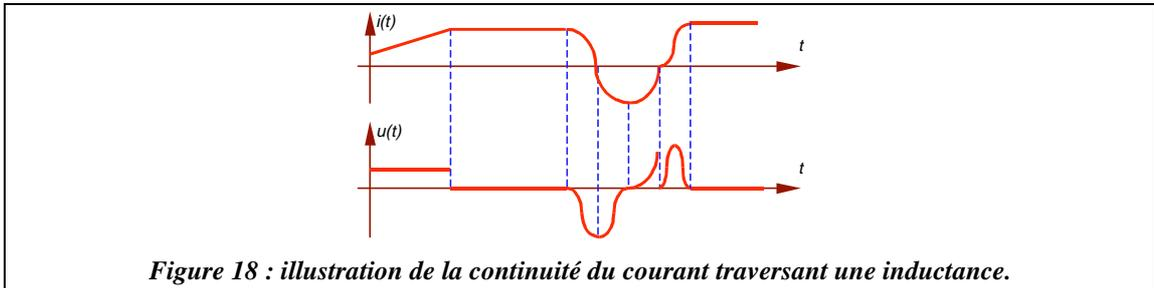
Figure 18 : illustration de la continuité du courant traversant une inductance.
